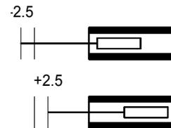
Die Polarität (zunehmendes oder abnehmendes Ausgangssignal bei Bewegung des Stößels in Richtung des elektrischen Anschlusses am Aufnehmer bzw. bei Drehung der Welle im Uhrzeigersinn) kann durch Vertauschen der Anschlüsse WM und WP geändert werden.
